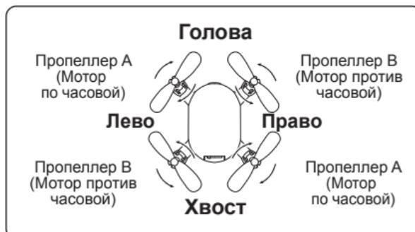
Включите модель и убедитесь, что пропеллер установлен в правильном положении. Пропеллер А на левом переднем и правом заднем углах должен вращаться по часовой стрелке; пропеллер В на правом переднем и левом заднем углах должен вращаться против часовой стрелки.
