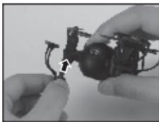
1. Вставьте основание модели в основание защитной рамки и подтолкните до фиксации защелками.
